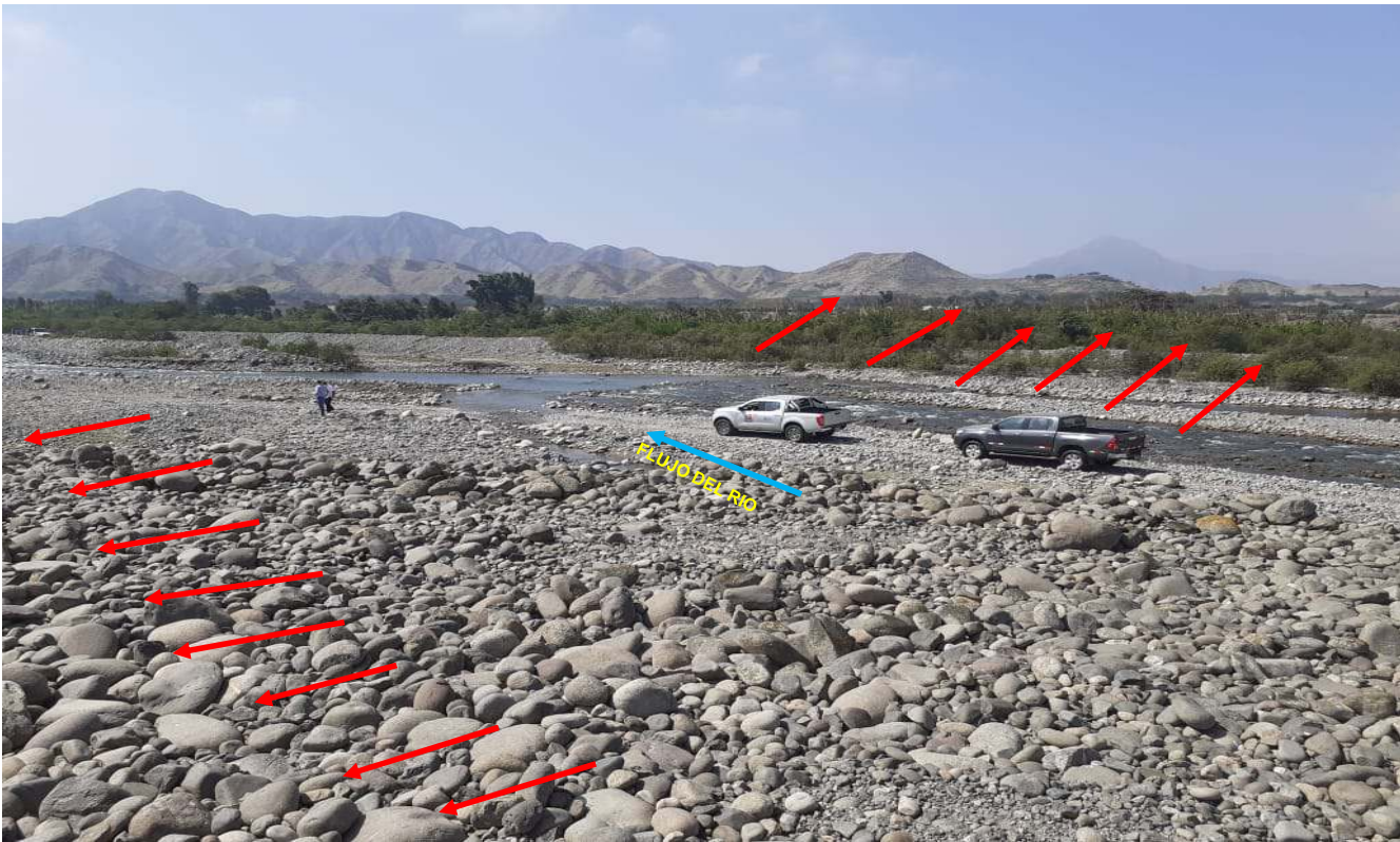
FIGURA N°03: EN LA TEMPORADA DE MAXIMAS AVENIDAS EL RÍO CHANCAY-HUARAL, SE DESBORDA, POR AMBAS MARGENES, EN EL SECTOR HORNILLOS-BOCATOMA LA ESPERANZA, DISTRITO DE AUCALLAMA/HUARAL, CUYO TRAMO SE ENCUENTRA COLMATADO Y
